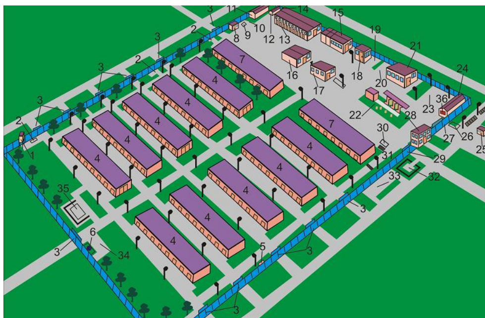
Рис. 1. Вариант размещения постоянного парка в пункте постоянной дислокации воинской части [7]: 4, 7 – хранилища для ВВТ; 8 – КПП; 11 – склады ВТИ; 12 – склад лакокрасочных и химических материалов; 13 – ПТОР; 14 – трансформаторная; 15 – аккумуляторные; 16 – ПЕТО; 17 – ПЧ и М; 18 – водогрейка; 19 – площадка для машин, ожидающих ремонта; 24 – помещение для дежурных средств; 25 – пункт предварительной очистки; 28 – КТП.
